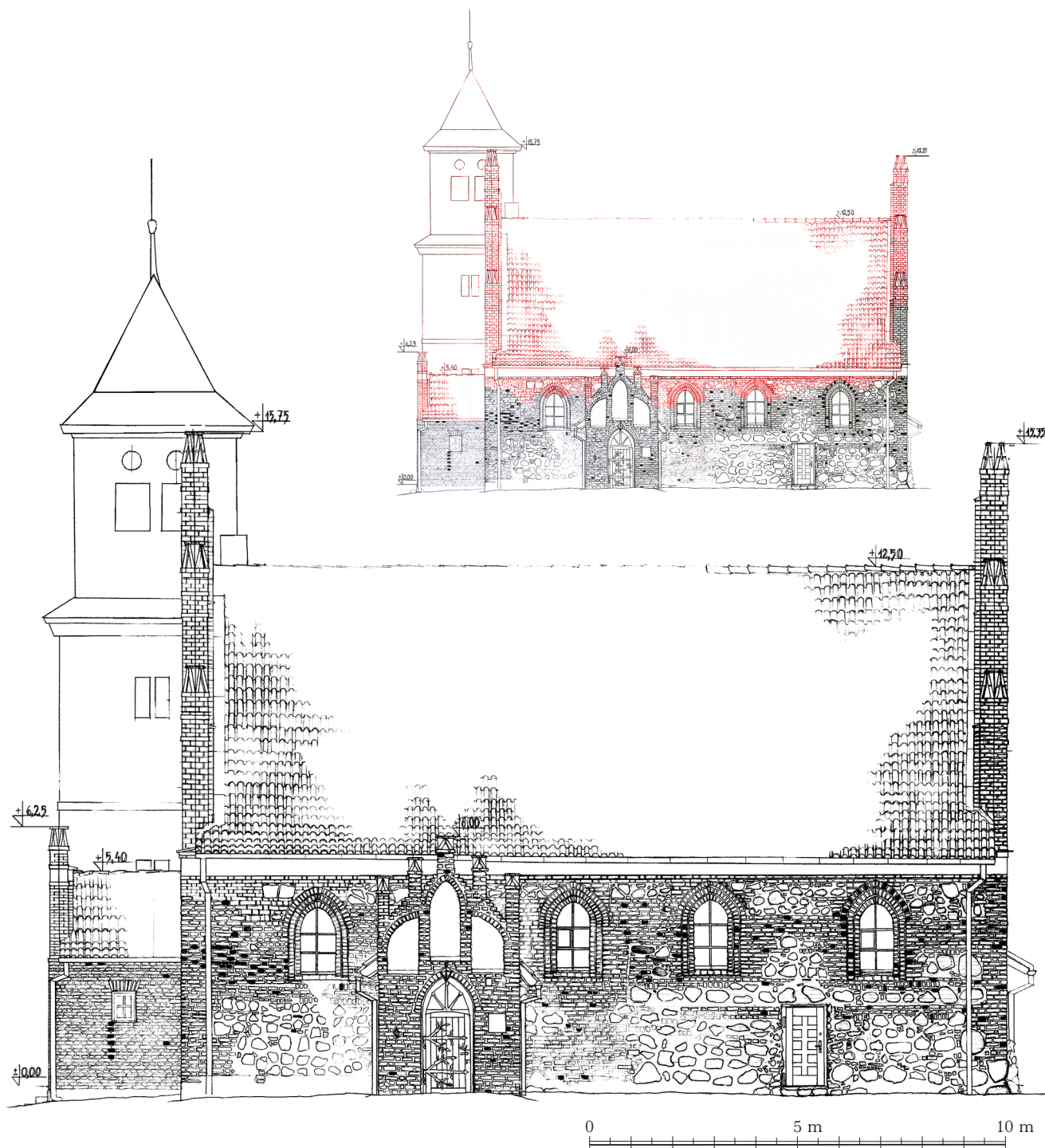
Ilustracja 6. Asuny, cerkiew pw. Zaśnięcia NMP, elewacja południowa. Pomiar wykonały Natasza Gródek i Zuzanna Izbicka, lipiec 2023. Zb. ZAP WAPW sygn. 4413. Elewacja z zaznaczeniem zakresu prac wykonanych wg projektu F. Heitmanna
